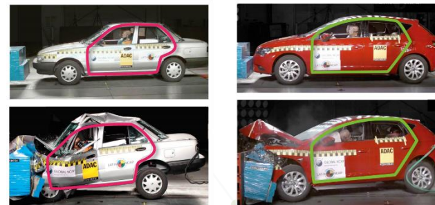
Choques realizados a 64 km/h con un traslape del 40% del frente del vehículo
