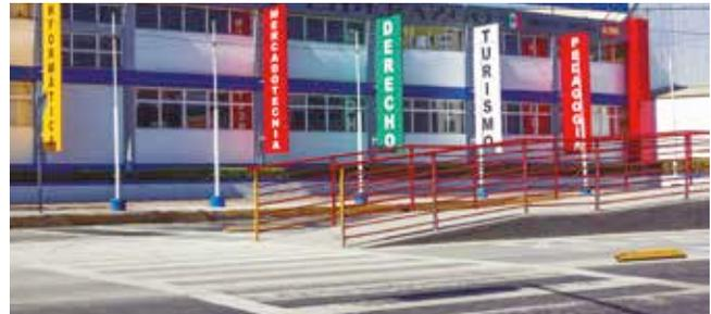
La falta de rampas o superficies al nivel del arroyo vehicular en banqueta, con que conectan el acceso de la estación con el entorno urbano, no permite el acceso a los servicios BRT.
