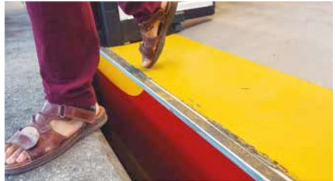
El espacio que se genera entre la unidad y la plataforma de abordaje no debe superar los 10 cm. Esto garantiza la seguridad de los usuarios en el abordaje, para lograr esto, los operadores deben estar en constante capacitación y supervisión constante.
