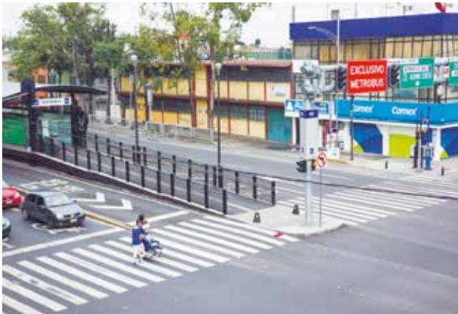
La marca de cruce peatonal debe trazarse sobre los carriles confinados y vehiculares de forma continua y totalmente visible. El rotulado debe tener contraste de acuerdo con el tipo del pavimento.
